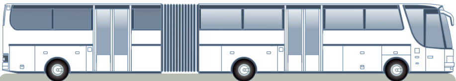
Autocar articulé (1 section) Longueur maxi : 18,75 m PTAC maxi : 28 t
